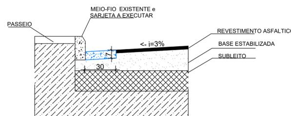
DETALHE MEIO-FIO E SARJETA CONJUGADOS SEM ESCALA
