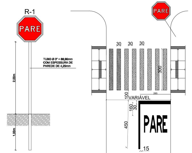
DET. TUBO DE INSTALAÇÃO DE PLACAS E SINALIZAÇÃO HORIZONTAL SEM ESCALA
